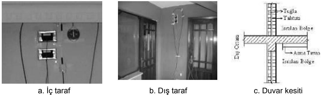
Şekil 1. Çift duvar arası yalıtımlı binada problemler ve veri depolama birimlerinin yerinde görünüşü ile ölçüm alınan kesite ait geometrik özellikler
