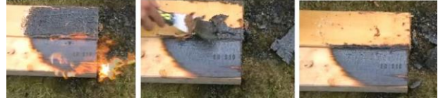
Şekil 37. Nano kaplama içeren ahşap elemanın (üstte) yangında tutuşmasının önlenmesi (Marzi, 2015).
