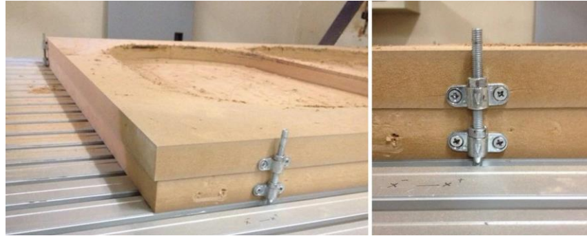
Resim 9: (a) Malzemenin sabitlenmesi (b) Sabitleme detayı
