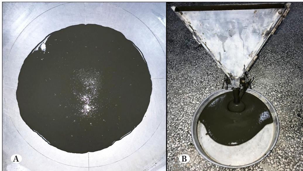
**Figure 2.** Flowability of SIFCON slurry (A) mini slump-flow (B) mini V-funnel.
