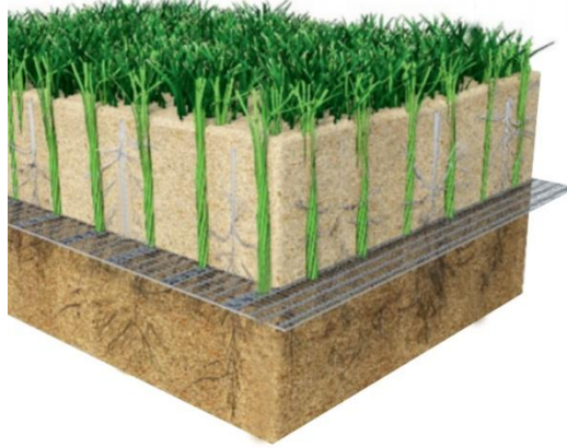
Şekil 2. Fibresand hibrit çim ( URL 4).
