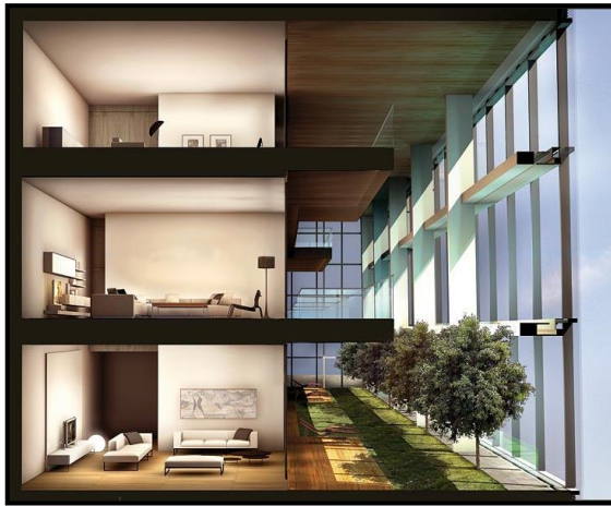
Şekil 3. İstanbul Sapphire, Çift Cıdarlı Cephe Sistemi ve İç Bahçe (RAF, 2010)
