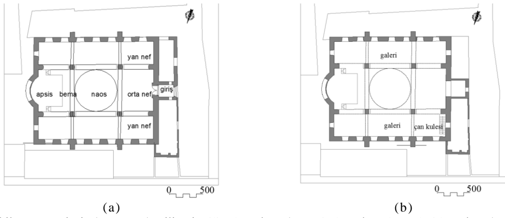
Şekil 8. Surp Pirgiç (Protestan) Kilisesi Kilise kat planı a) Zemin kat planı b) Galeri kat planı (DVBM Arşivi)
